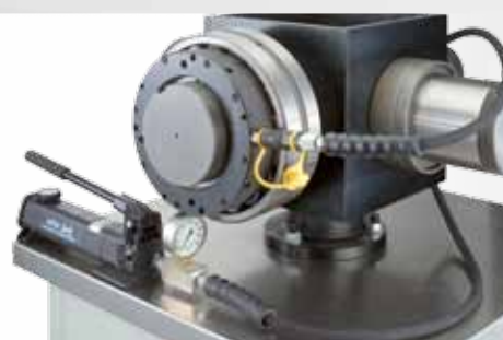
Montage sur manchon de serrage avec un écrou hydraulique.
