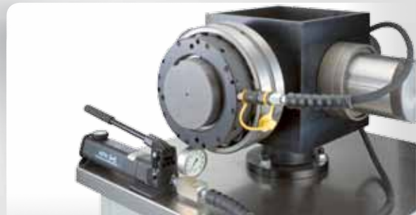
Extraction du manchon de démontage par l'écrou hydraulique
