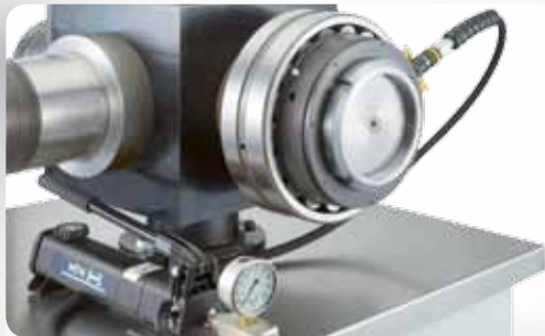
Extraction du manchon de serrage par l'écrou hydraulique
