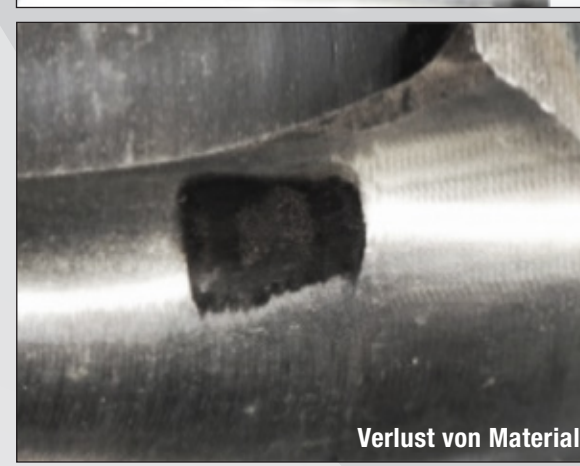
Abplatzungen an der Kugelnabe
