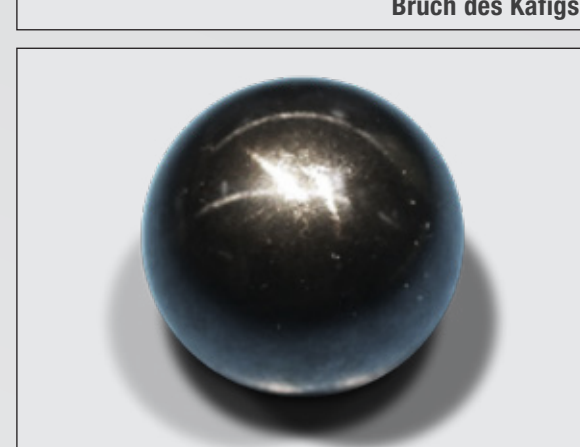
Beschädigung der Kugel
