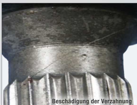
Beschädigung der Verzahnung
