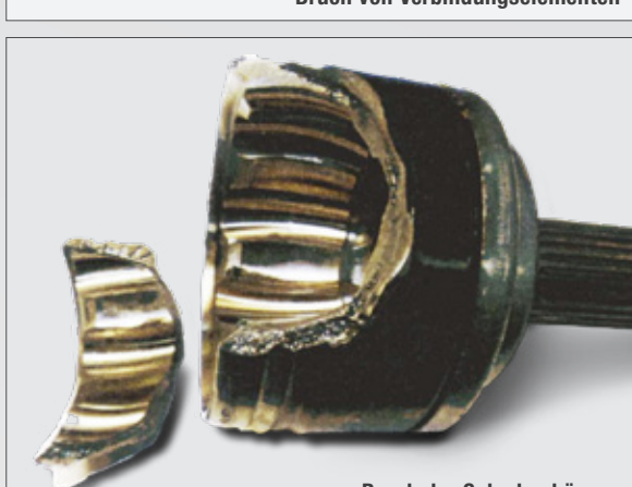
Bruch der Gelenkgehäuses
