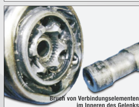
Bruch von Verbindungselementen im Inneren des Gelenks
