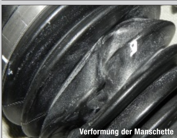
Verformung der Manschette
