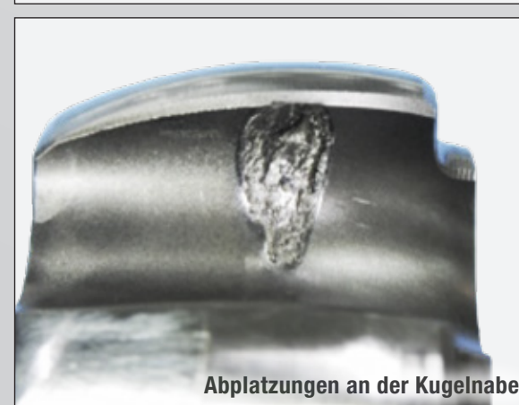
Abplatzungen an der Kugelnabe
