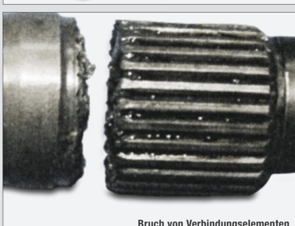
Bruch von Verbindungselementen
