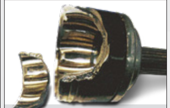
Rotura de la campana
