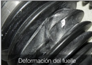
Pandeo = inversión de la forma del fuelle o deformación del fuelle
