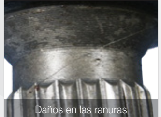
Rotura del vástago de la campana
