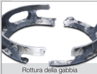
Rottura degli elementi di collegamento interni del giunto
