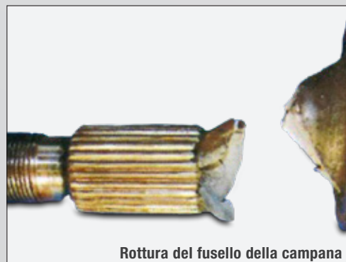
Rottura del fusello della campana
