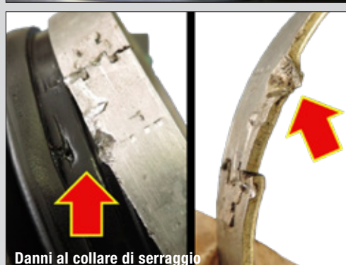
Danni al collare di serraggio
