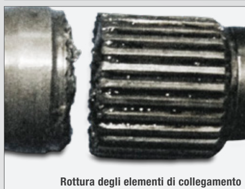
Rottura degli elementi di collegamento
