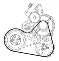
Führung des Nebentriebriemens (Fahrzeug ohne Klimaanlage)
