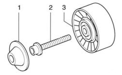
Einbauen der Führungsrolle (Ref. NTN-SNR GA357.06) (nur für Fahrzeuge mit Klimaanlage)
