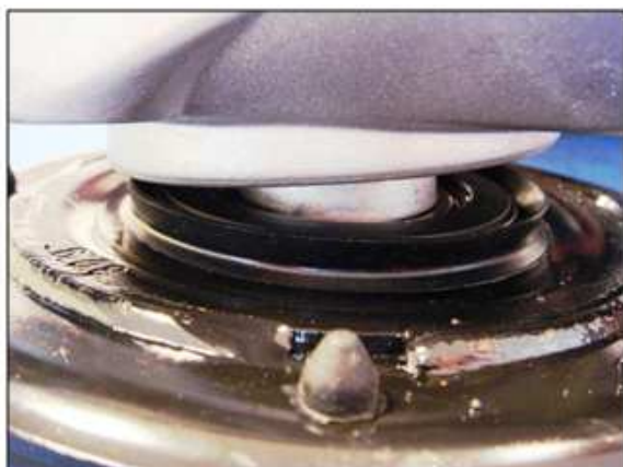
Встановлення блоку фільтра в тримачі
