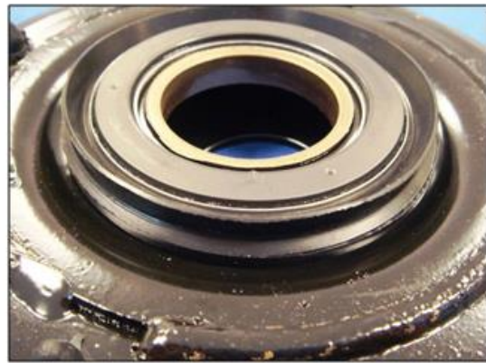
Montáž těsnění na doraz
