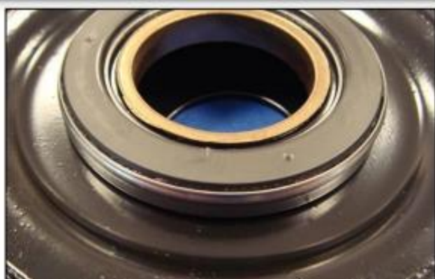
Montaje correcto del axial
