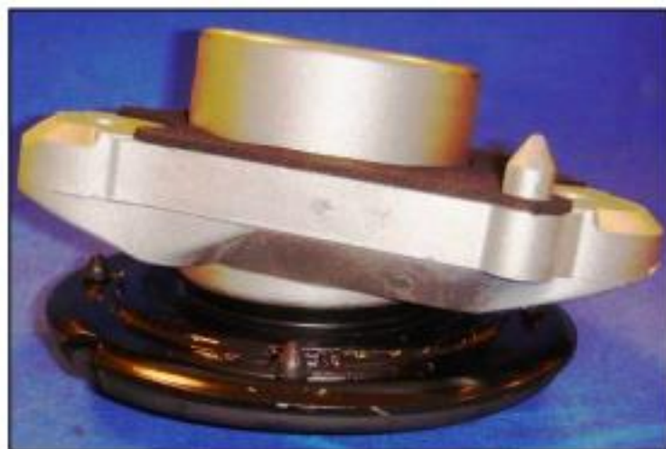
Окончательный вид опоры после сборки
