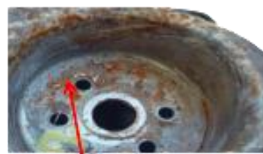
Koroze způsobené pohybem pružiny
