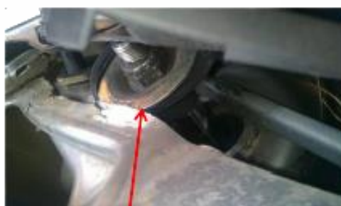
Nekvalitní díl ložisko zavěšení a jednotka oddělení Hřídel tlumiče prorazil karoserii
