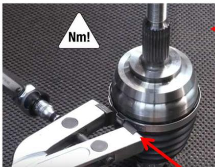
**Step 2:** rispettare le raccomandazioni di serraggio in funzione del  $\varnothing$  e/o delle larghezze dei collari.
