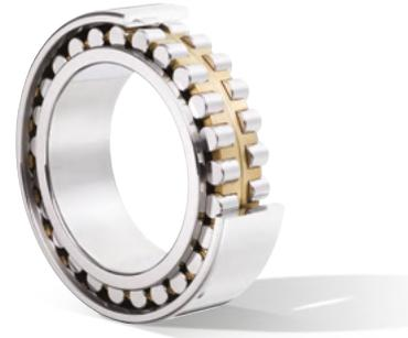
Les roulements à double rangée de rouleaux cylindriques sont conçus pour les applications à charges très élevées. Avec cage, ils offrent le meilleur compromis pour une vitesse de rotation modérée à élevée ; sans cage (type « full complement »), ils incorporent un nombre maximal de rouleaux pour une capacité de charge maximale.
