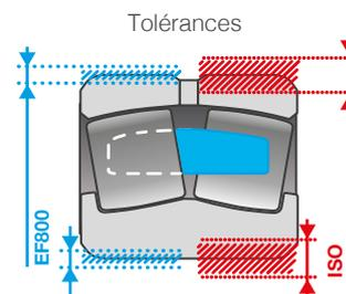
Tolérances réduites sur les alésages cylindriques et coniques et sur les diamètres extérieurs par rapport aux plages de tolérances des séries standards, garantissant un ajustement parfait de la bague
