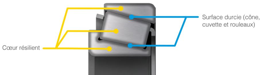
Section transversale d'un roulement en acier cémenté
