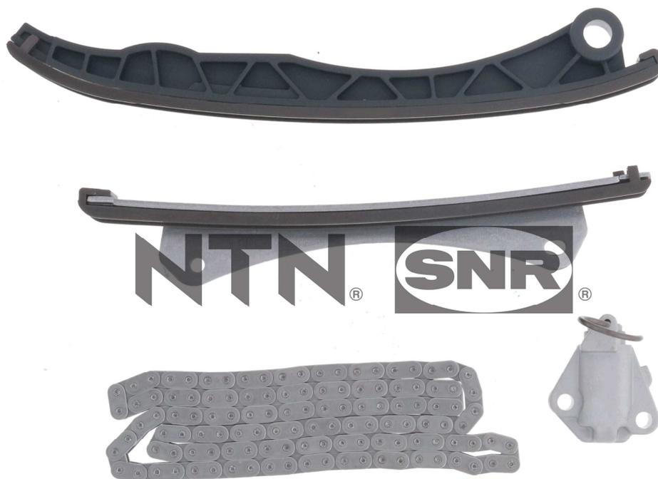
Il kit comprende solo la catena, le guide mobili e fisse e il tenditore idraulico. Ma NON include le viti, la guarnizione del carter di distribuzione, la guarnizione dell'albero a gomiti, gli ingranaggi dell'albero a gomiti e dell'albero a camme, né il tubo di lubrificazione dotato di spruzzatore d'olio, né il supporto di azionamento della pompa olio.
