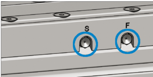
Bild 1.12 — Schlitteneinheit mit seitlichen Schmiernippeln
