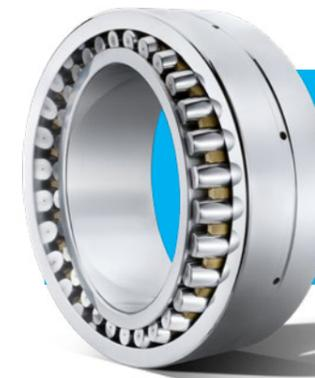
Pour les roulements à rouleaux, la charge minimale doit représenter au moins **2% de la charge radiale dynamique** (noté Cr dans le catalogue NTN).
