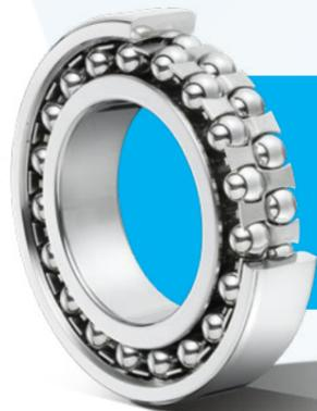
Pour les roulements à billes, la charge minimale doit représenter au moins **1% de la charge radiale dynamique** (noté Cr dans le catalogue NTN).
