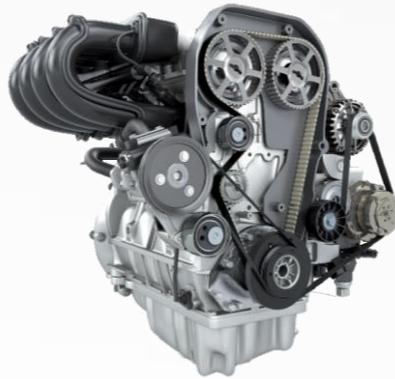
Es ist wichtig, die Beziehung zwischen der Wasserpumpe und dem Riemenantriebssystem nicht zu übersehen. Wenn ein Riemen, eine Umlenkrolle oder eine Spannrolle verschleiben oder falsch eingebaut sind, kann dies zu einem Ausfall der Wasserpumpe führen, ebenso wie eine defekte oder falsch eingebaute Wasserpumpe zu einem vorzeitigen Ausfall des Riemenantriebs führen kann, sei es der Motorsteuerriemen oder der Motorsteuerriemen.
