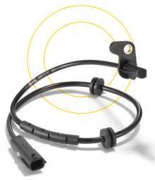
Das ASB® Sensorlager verfügt über eine magnetisch kodierte Dichtung mit einer präzisen Reihe von Nord- und Südpolen. Diese Pole werden während der Radumdrehung von einem Sensor erfasst, der ein digitales Signal entsprechend der Raddrehzahl erzeugt. Dieses Signal wird dann an die Steuergeräte des Fahrzeugs gesendet, um verschiedene Systeme wie ABS, ESP und andere Stabilitätskontroll- und Navigationssysteme zu steuern.
