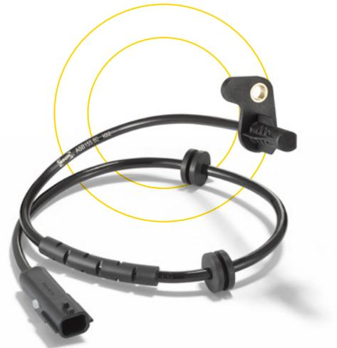
El rodamiento sensor ASB® está equipado de una junta de estanqueidad con codificador magnético con una serie precisa de polos norte y sur. Estos polos son detectados por un sensor cercano, que genera una señal digital correspondiente a la velocidad de rotación de la rueda. A continuación, esta señal se envía a las calculadoras del vehículo para gestionar diversos sistemas, como el ABS, el ESP y otros sistemas de control de estabilidad y navegación.
