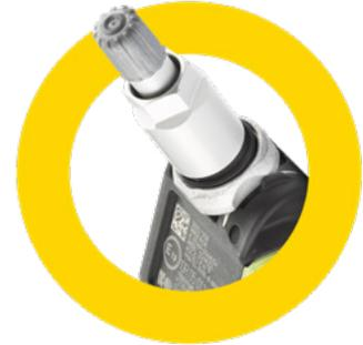
El sensor de control presión de los neumáticos, instalado en el interior de éstos y acoplado a la válvula, funciona con una pequeña batería incorporada. Utiliza una membrana piezoeléctrica para medir la presión (y a veces la temperatura). También transmite la información por ondas de radio a un receptor, que activa alertas visuales o sonoras en caso de presión anormal.
