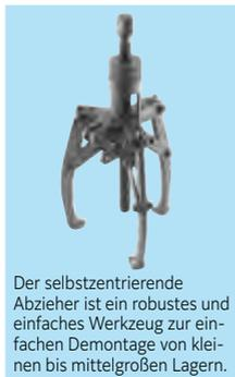
Der selbstzentrierende Abzieher ist ein robustes und einfaches Werkzeug zur einfachen Demontage von kleinen bis mittelgroßen Lagern.
