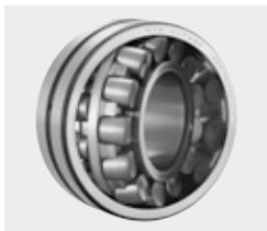
Bei Pendelrollenlagern der Baureihe ULTAGE™ mit hochfestem Käfig [EMA Ausführung] werden speziell bearbeitete Messingkäfige eingesetzt. Diese Lager eignen sich für Bergbaumaschinen (Schwingsiebe, Brecher usw.), die einer exzentrischen Rotation und Stoßbelastung ausgesetzt sind.
