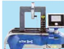
Das Induktionsanwärmgerät ermöglicht ein sicheres und schonendes Erwärmen von Lagern durch kontinuierliche Temperaturkontrolle, Überhitzungsschutz sowie Temperaturhaltefunktion mit abschließender Entmagnetisierung des erwärmten Bauteils.
