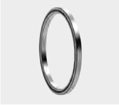
Die Kugellager in Dünnringausführung von **NTN** weisen einen besonders kleinen Querschnitt auf. Es gibt drei Kugellagerbaureihen mit besonders kleinem Querschnitt: Radiallager, Vierpunktlager und Schrägkugellager. Für alle Typen sind Lagerdichtungen verfügbar.
