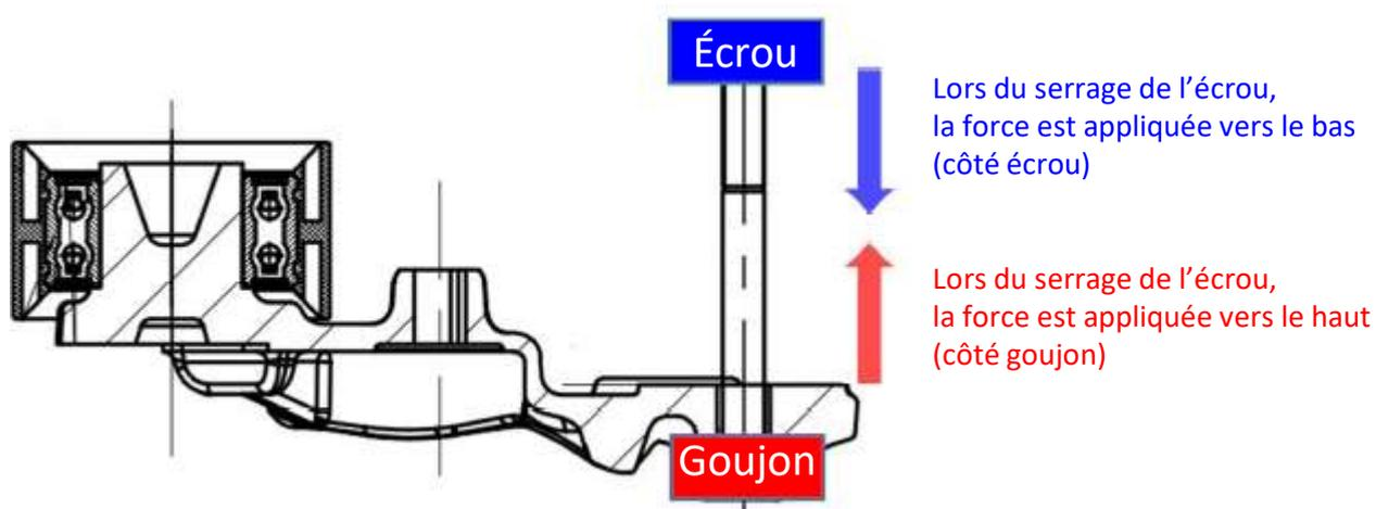
Lors du serrage de l'écrou, une force est appliquée vers le bas sur l'écrou et vers le haut sur le goujon, de sorte qu'un serrage normal est obtenu
