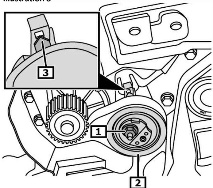
1 Galet tendeur de la courroie crantée
