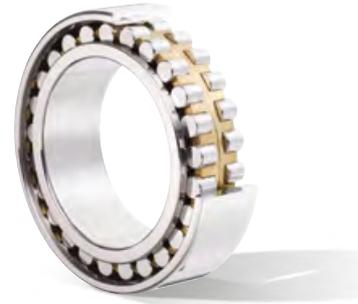
Zweireihige Zylinderrollenlager sind für Anwendungen mit sehr hohen Belastungen konzipiert. Mit Käfig bieten sie den besten Kompromiss für mittlere bis hohe Drehzahlen; ohne Käfig (vollrollig) enthalten sie die maximale Anzahl von Rollen für die maximale Tragfähigkeit.
