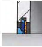
Junta de V-ring Fricción reducida
