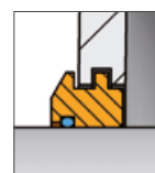
Junta de laberinto Muy adecuado para aplicaciones de alta temperatura
