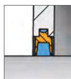
Junta de fieltro Adecuado para una mayor velocidad de rotación del eje
