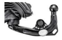
Conduire en marche arrière une voiture attelée d'une remorque est toujours délicat. Les réactions de la direction sont contraires aux intuitions et un conducteur peu expérimenté réagit souvent de manière désordonnée. Westfalia-Automotive a développé un nouveau système de mesure d'angle entre le véhicule tracteur et la remorque, système qui a notamment permis le développement de l'aide au remorquage récemment inauguré sur le nouvel Audi Q7.
