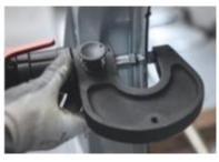
La pince GYSPRESS 8T permet de reproduire les opérations de rivetage réalisées par les imposantes riveteuses hydrauliques que l'on trouve dans les usines de production. Son principal avantage est qu'elle regroupe en 30cm, les mêmes technologies mécaniques qu'une riveteuse habituelle.
