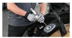
L'adhésif de réparation polyuréthane bicomposant à prise rapide TEROSON PU 9225 SF ME s'utilise notamment pour répararer des matériaux plastiques d'intérieur ou d'extérieur, en particulier pour les rayures ou les trous dans les pare-chocs, ailerons, jupes, etc., sur des zones endommagées de moins de 7cm. Grâce à la technologie MicroEmission™, il ne fait pas l'objet de mention de danger
