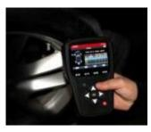
Le VT56 est un outil TPMS universel, conçu pour activer tous les capteurs TPMS et stocker les données de capteurs. Avec le connecteur OBDII ces données peuvent être transférées au véhicule pour réinitialiser l'ECU lorsqu'un capteur est remplacé ou que les positions de roues sont modifiées.
