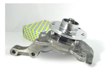
Un rodamiento de rueda sensor de esfuerzos ASB3®: se trata de un rodamiento de última generación de tipo de doble brida cuyo anillo exterior incorpora indicadores de restricciones. Un sistema electrónico acondiciona las señales eléctricas y un algoritmo las transforma en esfuerzos, analizados en continuo por la rueda.
