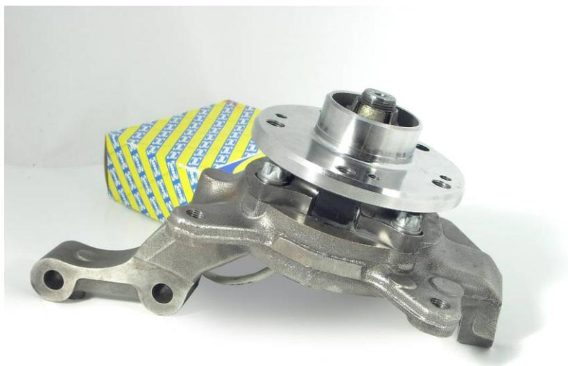
**Un roulement de roue capteur d'efforts ASB3®** : il s'agit d'un roulement de dernière génération de type biflasque dont la bague extérieure est équipée de jauges de contraintes. Une électronique conditionne les signaux électriques et un algorithme les transforme en efforts analysés par la roue en continu.
